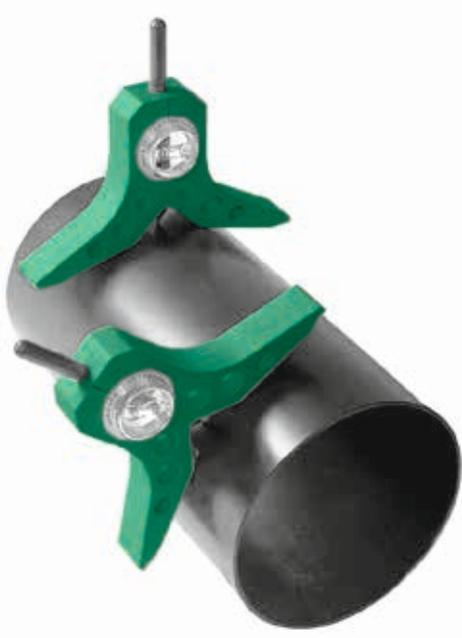
使用置中机头可以快速准确地建立管道中心线，定位罐槽或管道上的点，测量斜度，确立角度和铺设键槽。置中机头工具可用于测量和标记管道、法兰或装置周围不同的点。材料：阳极氧化铝。冲床：工具钢，硬化。
